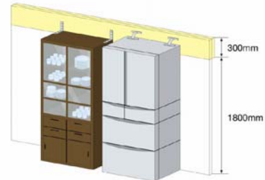
<食器棚・冷蔵庫固定用下地イメージ図>
